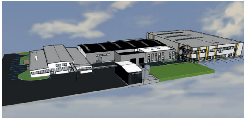
Oben: Das 3D-Modell des Bestandsgebäudes, übertragen aus der Punktwolke.
