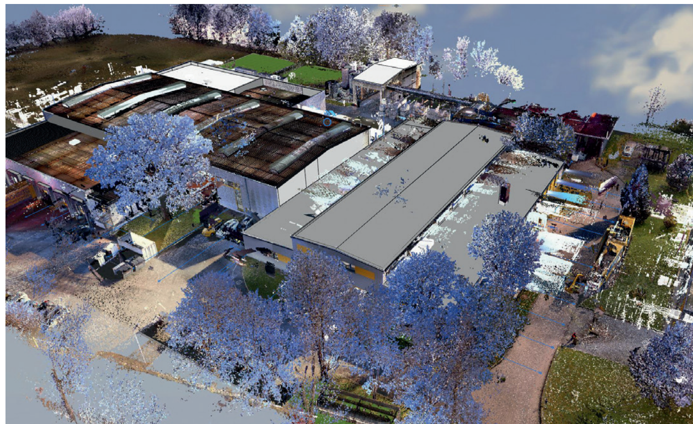
Das Neubau-3D-Modell kann in der Punktwolke an das Modell des Bestandsbaus angeschlossen werden.
