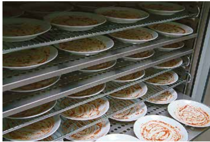
Mit Hackfleisch präparierte Teller warten auf ihren Einsatz beim Test von Spülmaschinentabs.
