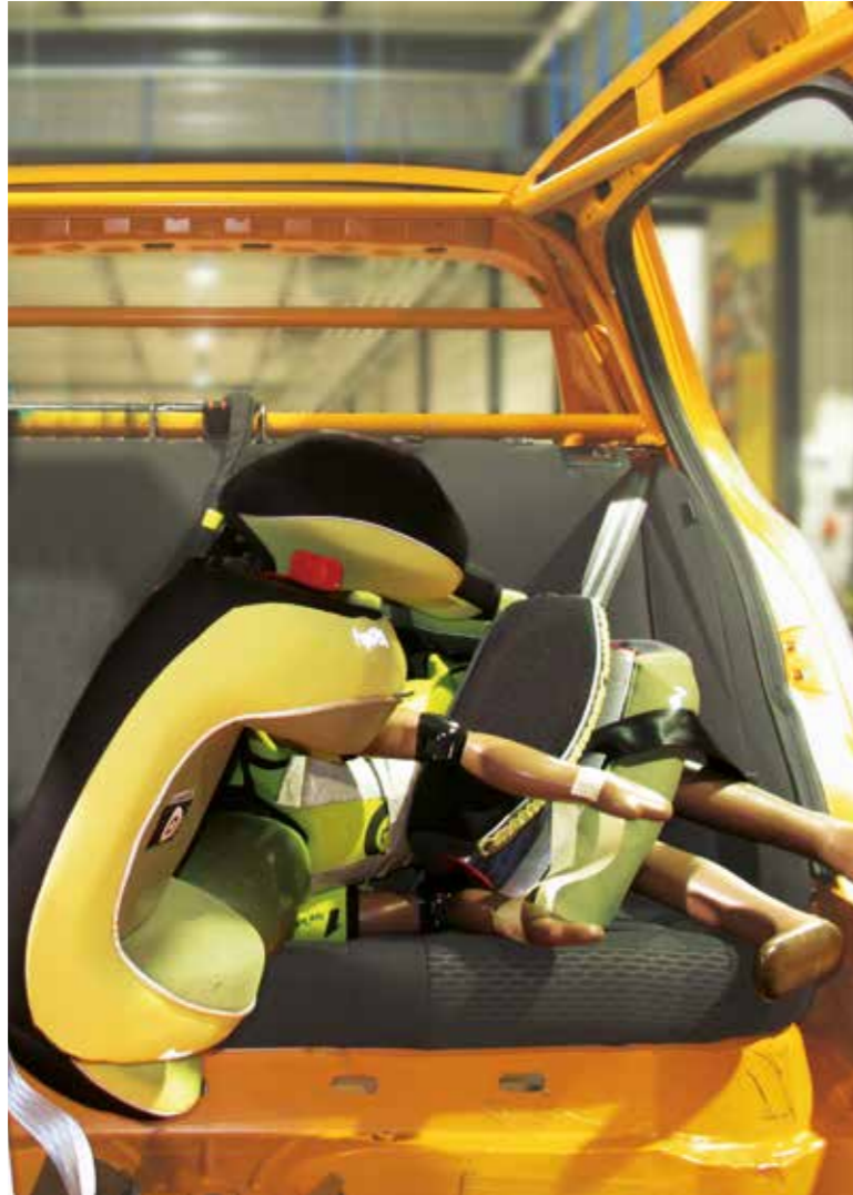
Kindersitze werden in einem Crashtest geprüft, der einer realistischen Unfallsituation nahekommt.
