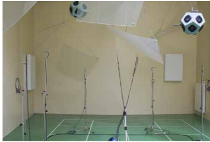
Bei vielen Produkten spielt auch die Lautstärke eine Rolle. So wird die Akkustik-Prüfung zum Beispiel bei Staubsaugern durchgeführt.
